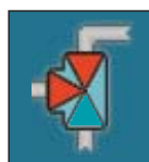
3-putni preklopni ventil s prikazom otvoreno i zatvorenog voda
